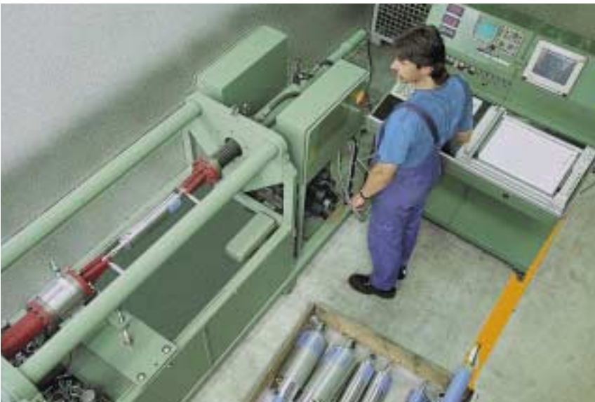
Banc d'essai transportable piloté par p.c. dans une centrale nucléaire Belge.
